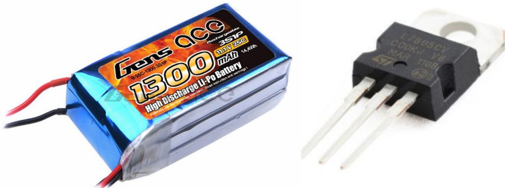
Slika 20: Uporabljena baterija na robotu ter regulator napetosti LM7805
